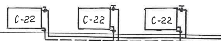
Schemat podłączenia grzejników
